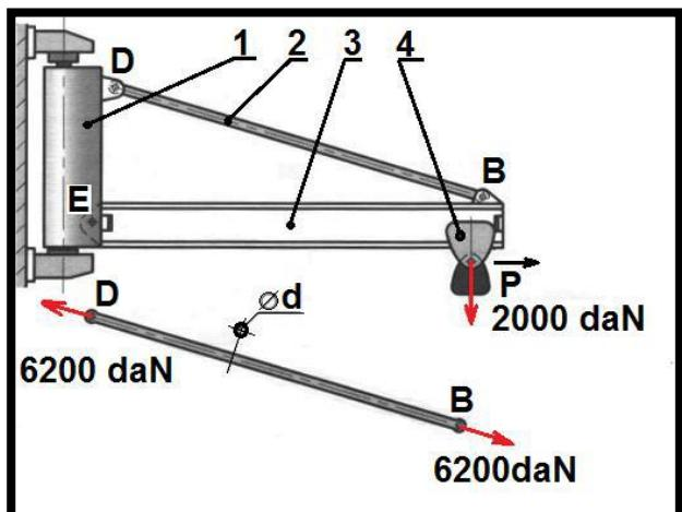
La potence à tirant proposée est utilisée en manutention pour lever et déplacer des charges. Elle se compose d'un palan 4, d'une poutre-rail 3, d'un fût pivotant 1 et du tirant 2.
