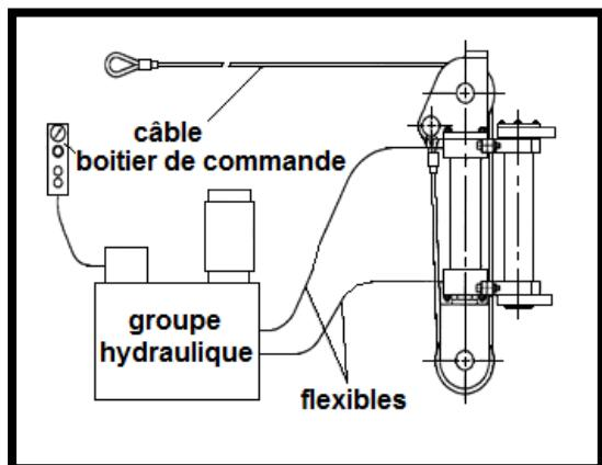
Le câble du treuil hydraulique est soumis à une charge de 3150 daN lors du fonctionnement. Ce câble à un diamètre de 20 mm. Il est réalisé en acier 42 Cr Mo 4. Compte tenu des conditions de sécurité, on impose un coefficient  $s = 8$ .
